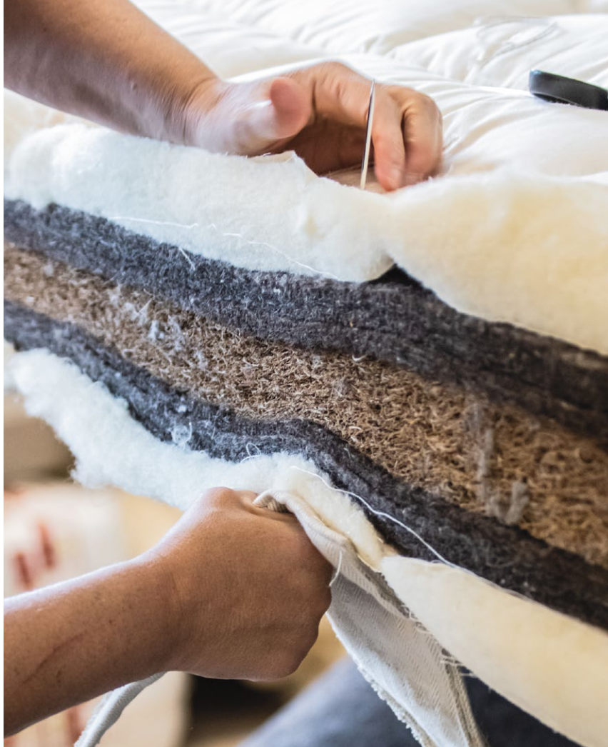
Für eine hohe Qualität und gute Träume: Kokos, Schafwollfilz und -vlies werden in der Wollwerkstatt im Mostviertel in Handarbeit zu einer Matratze verbunden ( www.wollwerkstatt.at ).
